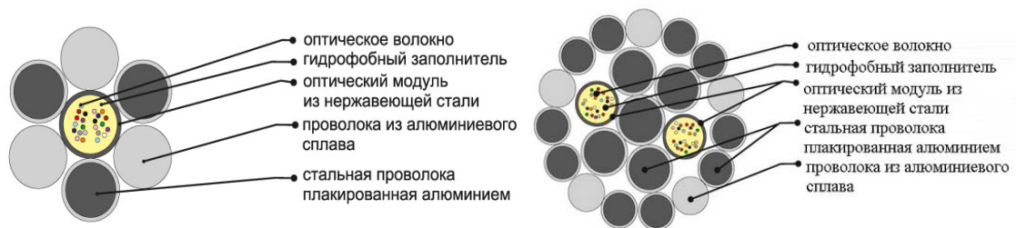
Рис. 1 – Модификации кабелей ОКГТ. а) ОКГТ-ц; б) ОКГТ-с.
