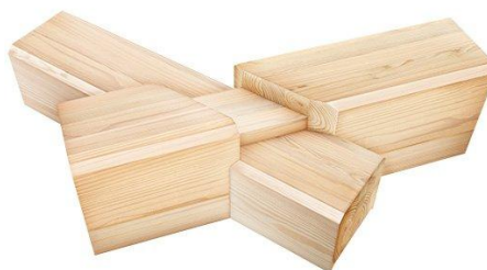
Рис. 9. – Соединение «В чашу» под углами 30, 45 градусов
