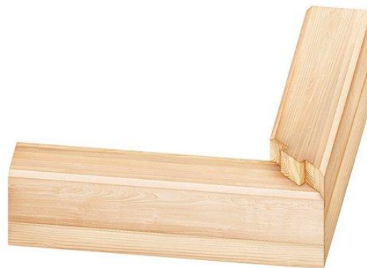
Рис. 5. – Соединение «Коренной шип» под углом 90 градусов
