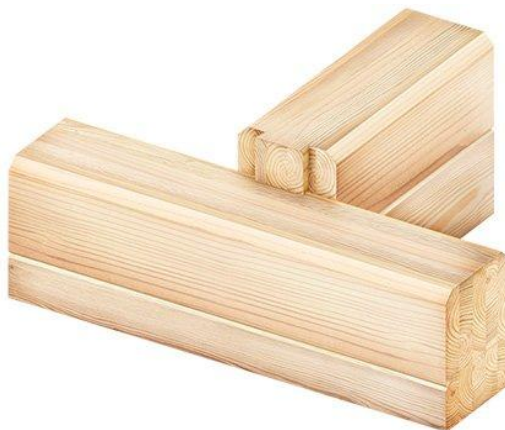
Рис. 7. – Соединение «Коренной Т-образный шип»
