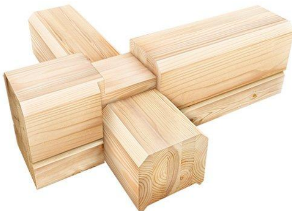
Рис. 8. – Соединение «В чашу» под углом 90 градусов
