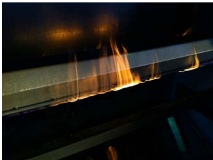
Рис. 5. – Появление языков пламени на корпусе ГИИ
