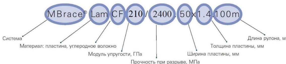
Рис. 2. – Ламели MBRACE LAM CF210/2400.50x1, 4.100m (Авторская разработка)
