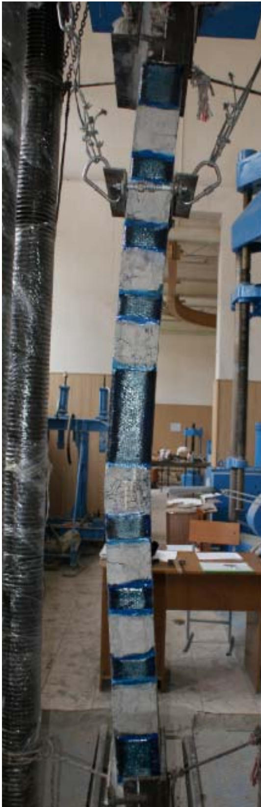
Рис. 4. Характер разрушения гибкой стойки БГУ- X_3 при величине e_0=2,0 см (0,16h).
