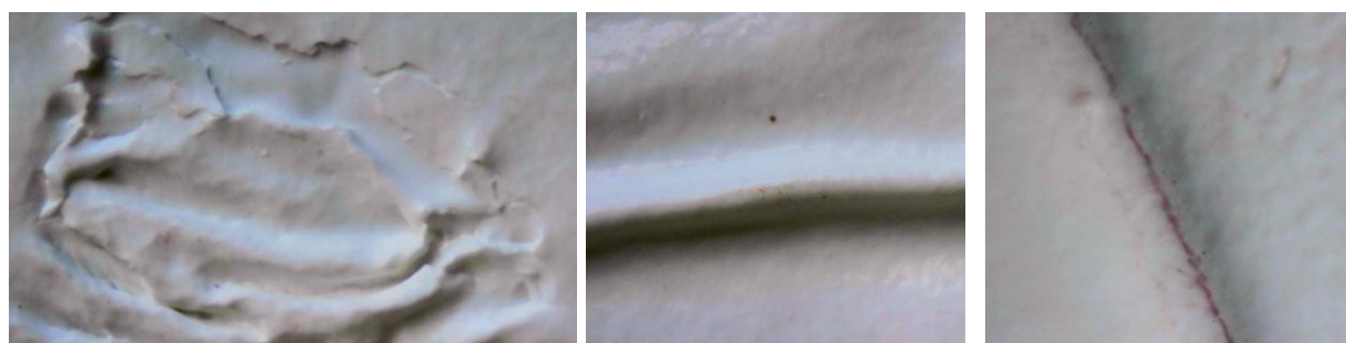
Рис. 3. – Дефекты на поверхности Tikkurila Metallista, белый (500X): сморщивание– (а); вздутие – (б), трещина – (в)
