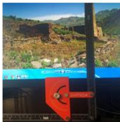
Рис. 3 – Измерение углов наклона стеновых конструкций угломером
