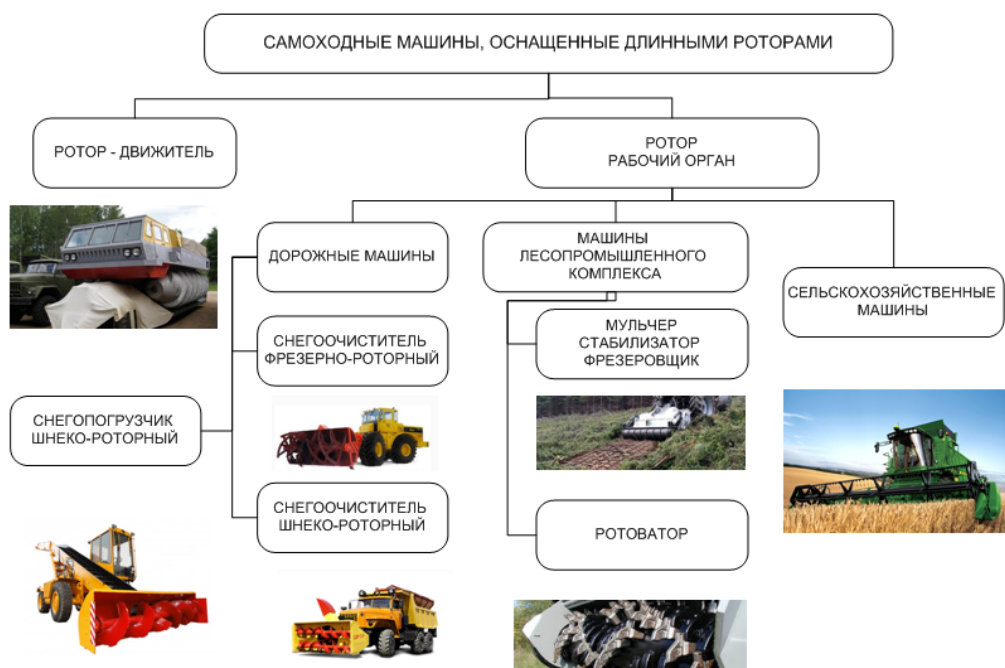
Рис. 1. - Структурная схема классификации машин, оснащенных двухопорными винтовыми роторами, подверженными осевым нагрузкам.
