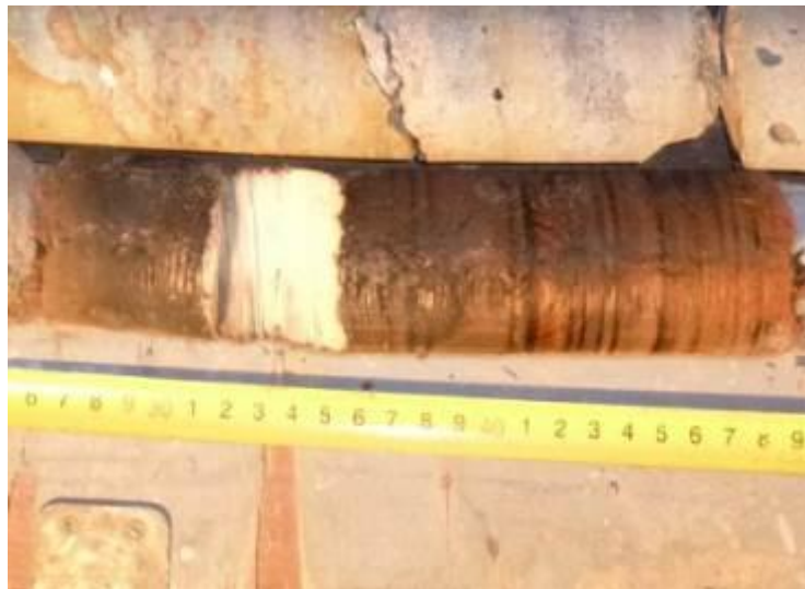
Рис. 2. Керны, отобранные из тела фундаментов Центральной башни здания Главного Адмиралтейства (строительство 1734 г.) (фото выполнено авторами)
