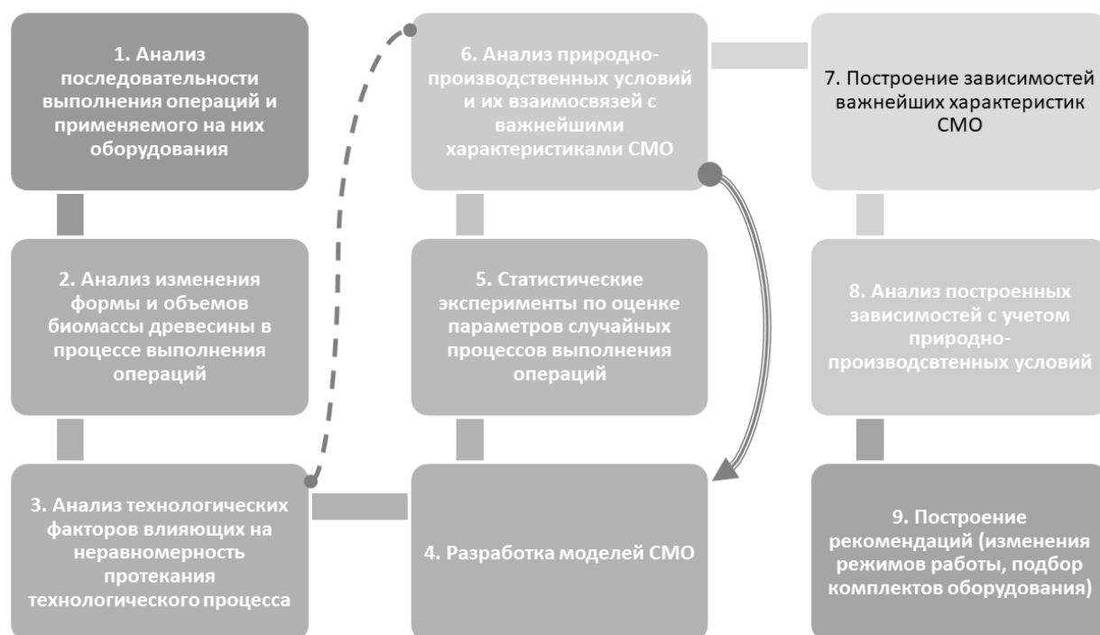
Рис. 1 – Этапы методики обоснования режимов работы оборудования и комплектования его в технологические линии и комплексы
