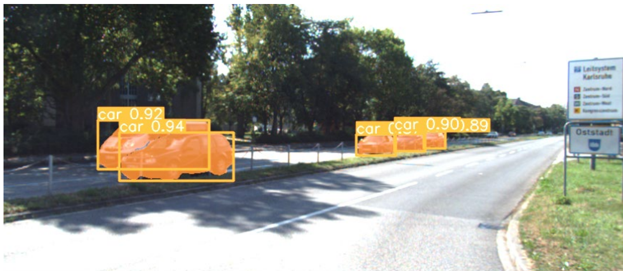
Рис. 3. Пример сегментации кадра с использованием модели YOLO-v8
