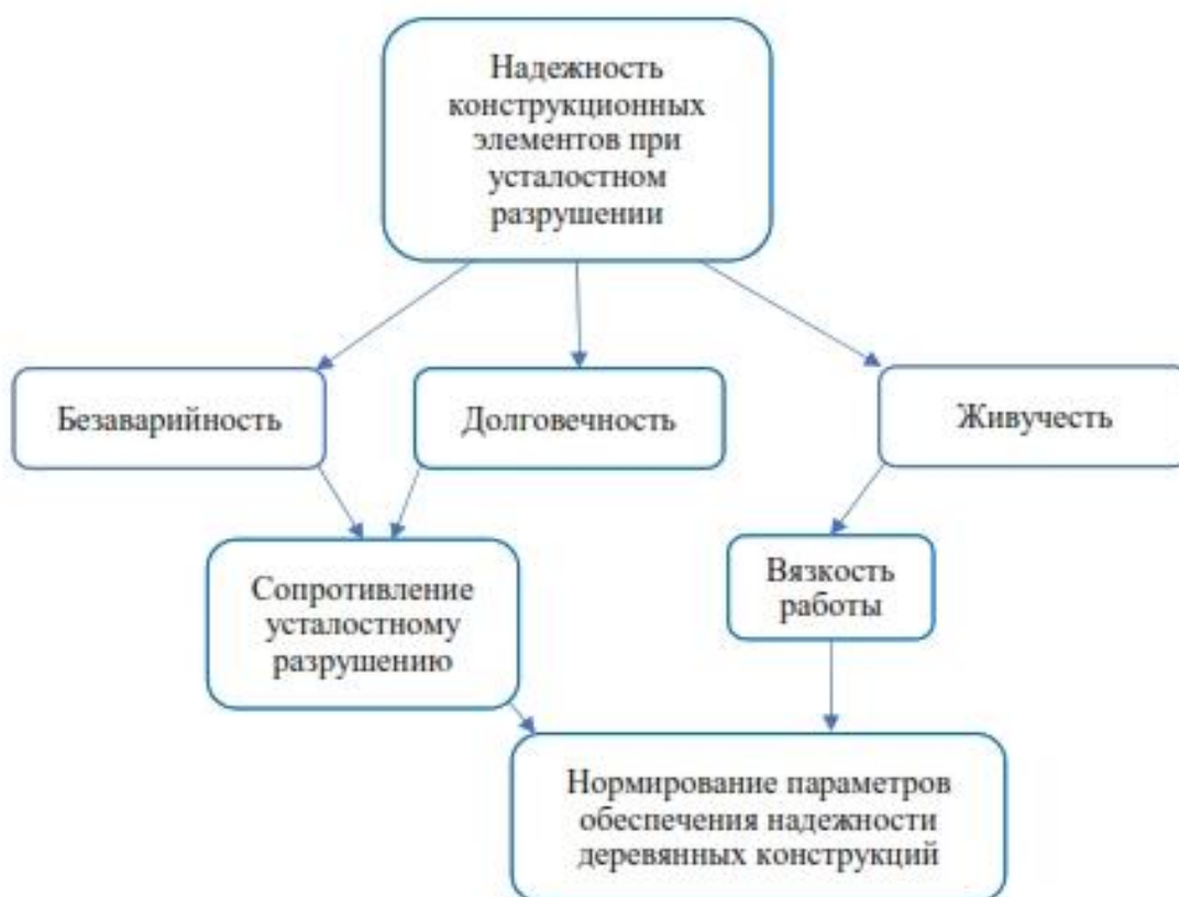
Рисунок 1. Структура надежности элементов деревянных конструкций
