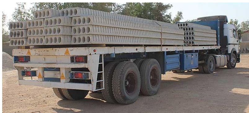
Рис. 2. – Перевозка плит перекрытий автотранспортом
