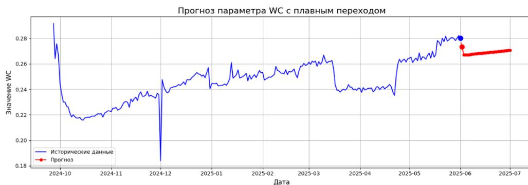
Рис. 5. – Общий график, включающий исторические данные по обводненности и прогноз на месяц вперёд.
