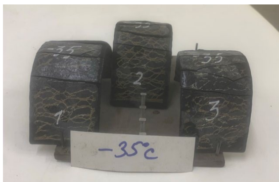
Рис. 5. – Образцы, сгибаемые поперек волокон при температуре -35^{\circ}\text{C} и нагретые до температуры 50^{\circ}\text{C} : а) после охлаждения, б) после нагрева
