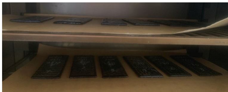
Рис. 3. – Выдерживание образцов в температурной камере при повышенной температуре
