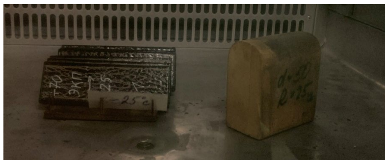
Рис. 2. – Выдерживание образцов и испытательного бруса в температурной камере при отрицательной температуре
