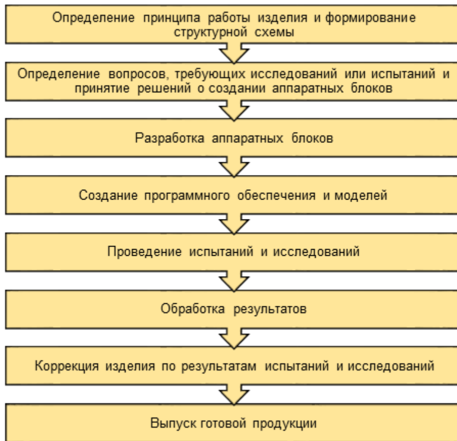
Рис. 1 – Этапы разработки устройств с применением методов полунатурного моделирования
