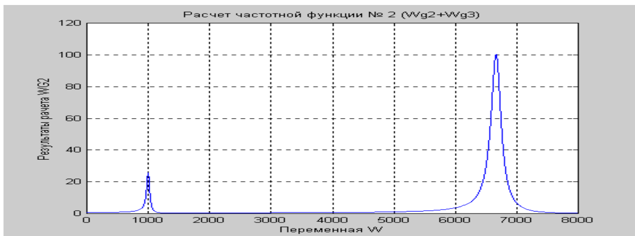
Рис. 2. – Модель спектра сигнала упругой системы
