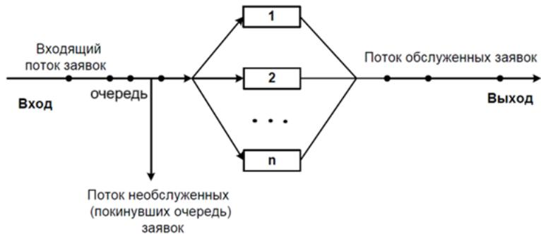
Рис.1 Схема потока обслуживания заявок
