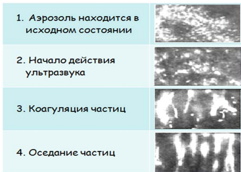
Рис. 3 – Коагуляция дыма под действием ультразвука
