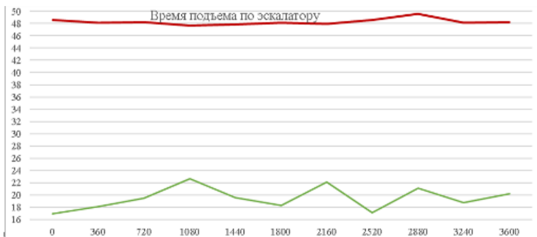
Рис. 6. –Время подъема пассажиров на каждом эскалаторе (красная кривая – левый, зеленая – правый эскалатор)
