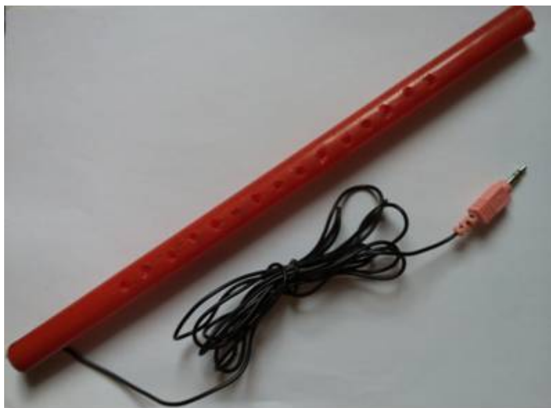
Рис. 1. – Направленный микрофон типа “бегущая волна”
