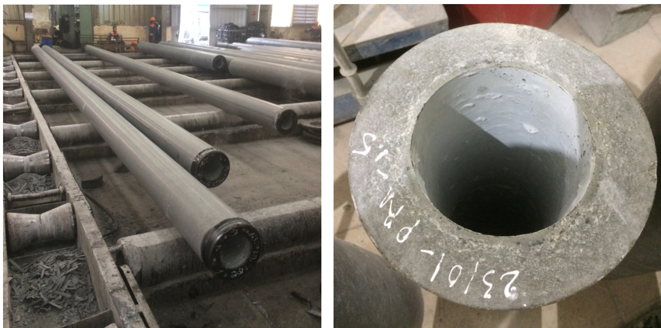
Рис. 1. – Цех по производству центрифугированных опор и центрифугированный образец для определения предела прочности
