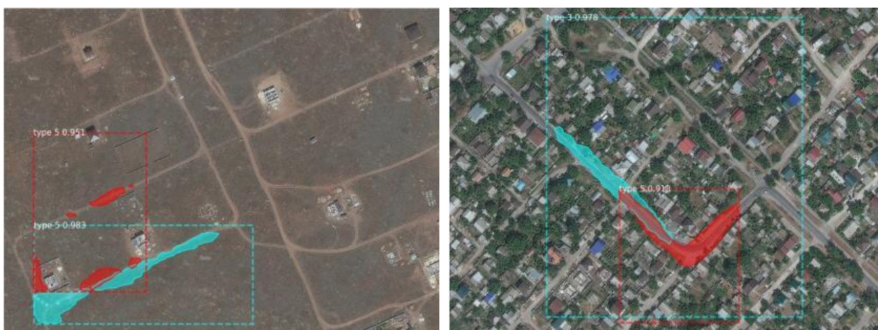
а – результат распознавания дороги type 5 б – результат распознавания дороги type 3
