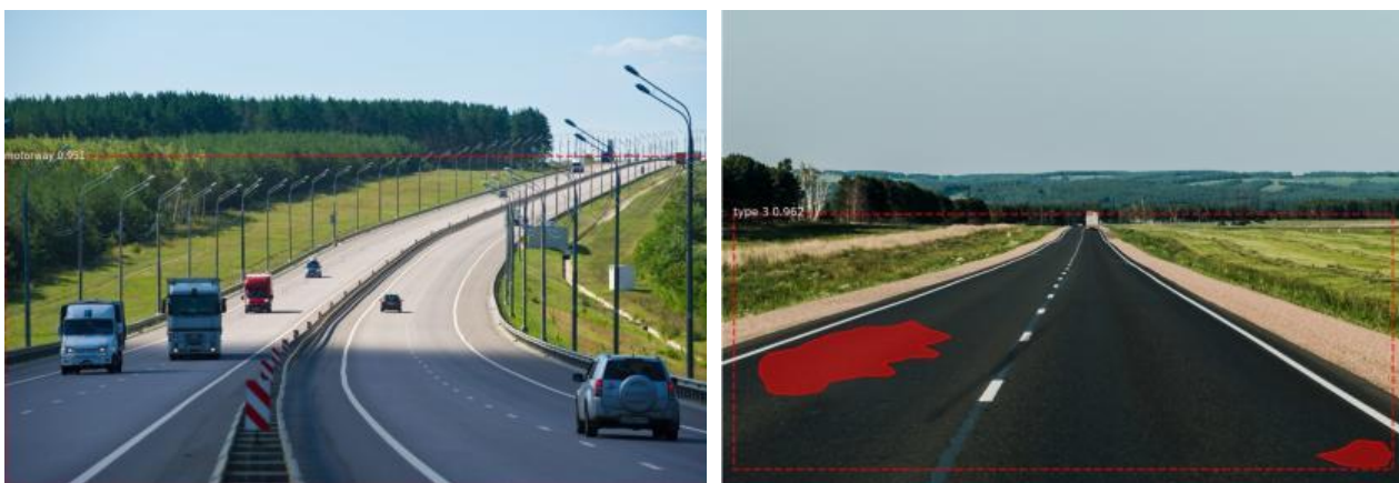
а – результат распознавания motorway б – результат распознавания дороги type 3
