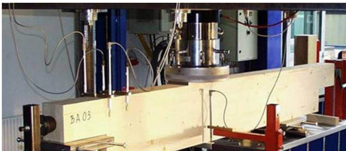
Рис. 2. – Балка из бруса, армированного стекловолокном с подрезкой в зоне опорного узла, в процессе испытаний
