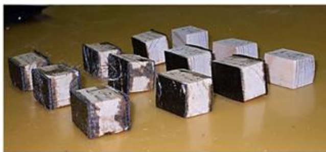
Рис.3. Образцы древесины, армированной полимерным композитом для смятия поперек волокон: а - Геометрические размеры и схема нагружения образца; б - Общий вид образцов при сжатии поперек волокон.
