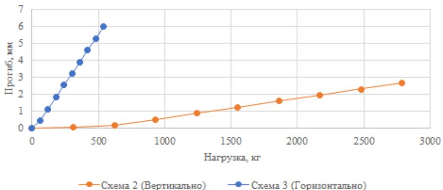
Рис. 6. – Деформации перемычки от нагрузки (схемы 2 и 3)
