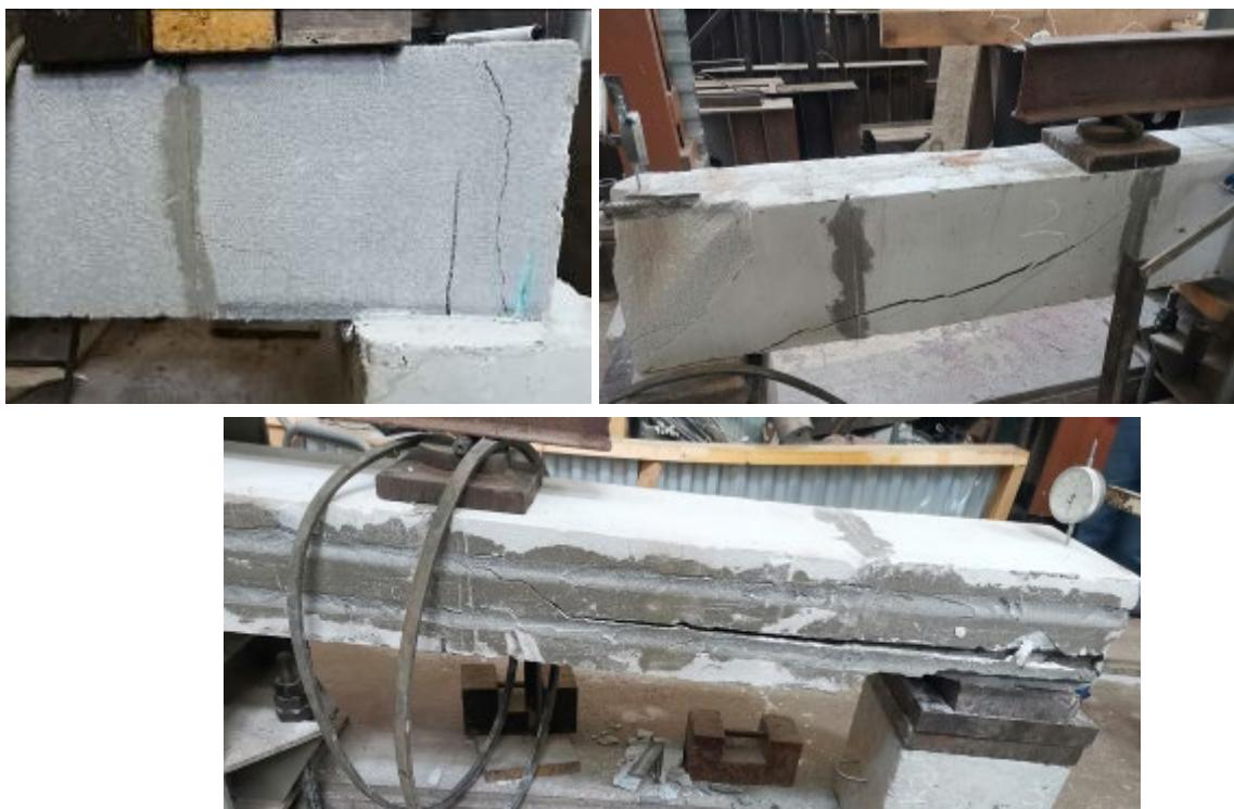
Рис. 7. – Разрушение газобетонной перемычки (Схемы 1, 2 и 3 соответственно)
