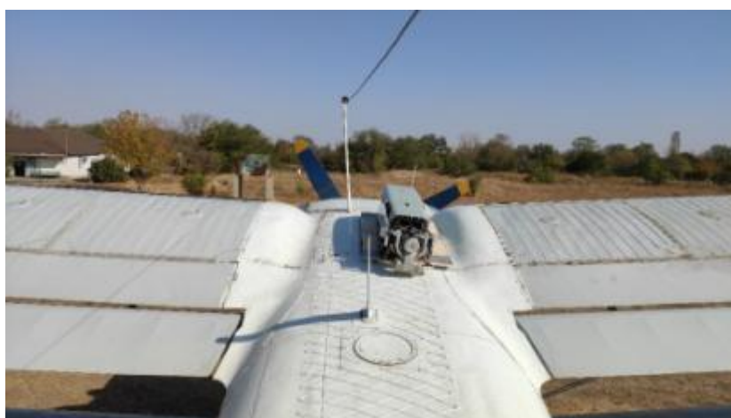
Рис. 8. БВС, закрепленный на фюзеляже самолета АН-2
