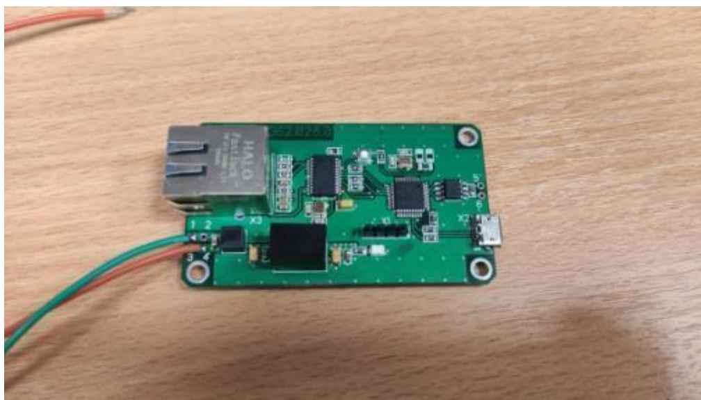
Рис. 10. Блок преобразования интерфейса, конструктивное исполнение
