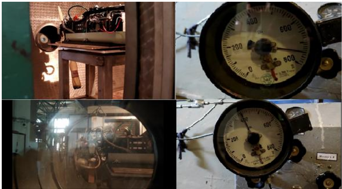
Рис. 7. Настройка ДВС в барокамере
